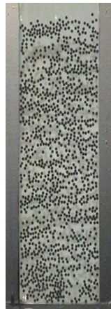
Fig. 1 – Image prise pendant l'expérience, Re_p = 389 et \phi = 0,20 pour l'huile.
