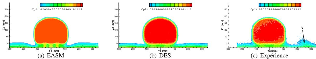
FIG. 2 – Coefficient de pression totale à  $Xo/L = 0.60$  pour  $\beta = 0^\circ$
