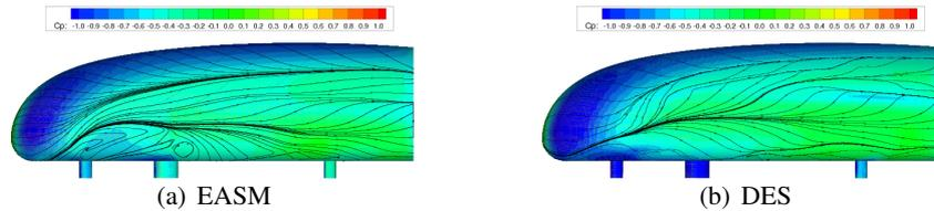
FIG. 10 – Coefficient de pression sur le côté sous le vent pour  $\beta = 30^\circ$
