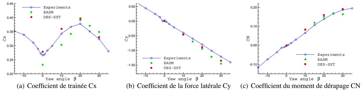
FIG. 12 – Efforts dans le repère (X, Y, Z) en fonction de l'angle de dérapage  $\beta$
