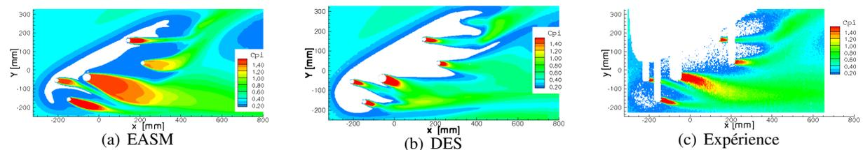
FIG. 8 – Coefficient de pression totale à  $Zo = -14.5$  mm pour  $\beta = 30^\circ$
