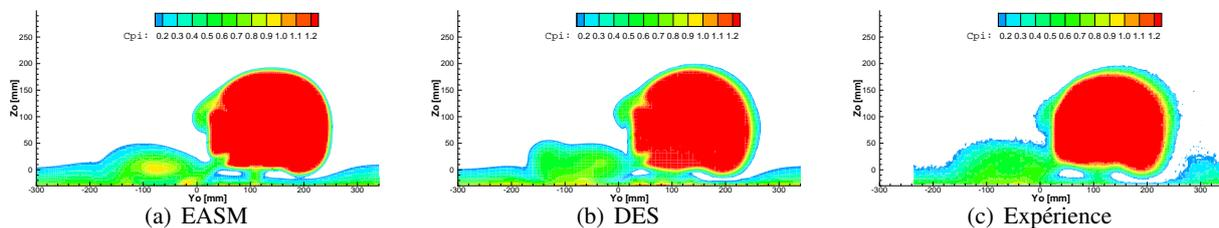
FIG. 4 – Coefficient de pression totale à  $Xo/L = 0.60$  pour  $\beta = 20^\circ$
