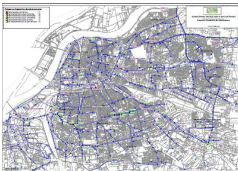
Figure 2 : modèle mathématique du réseau d'assainissement
