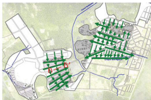
Figure 5 : Principes du dispositif secondaire de collecte et de transport des eaux pluviales et coupe BB'
