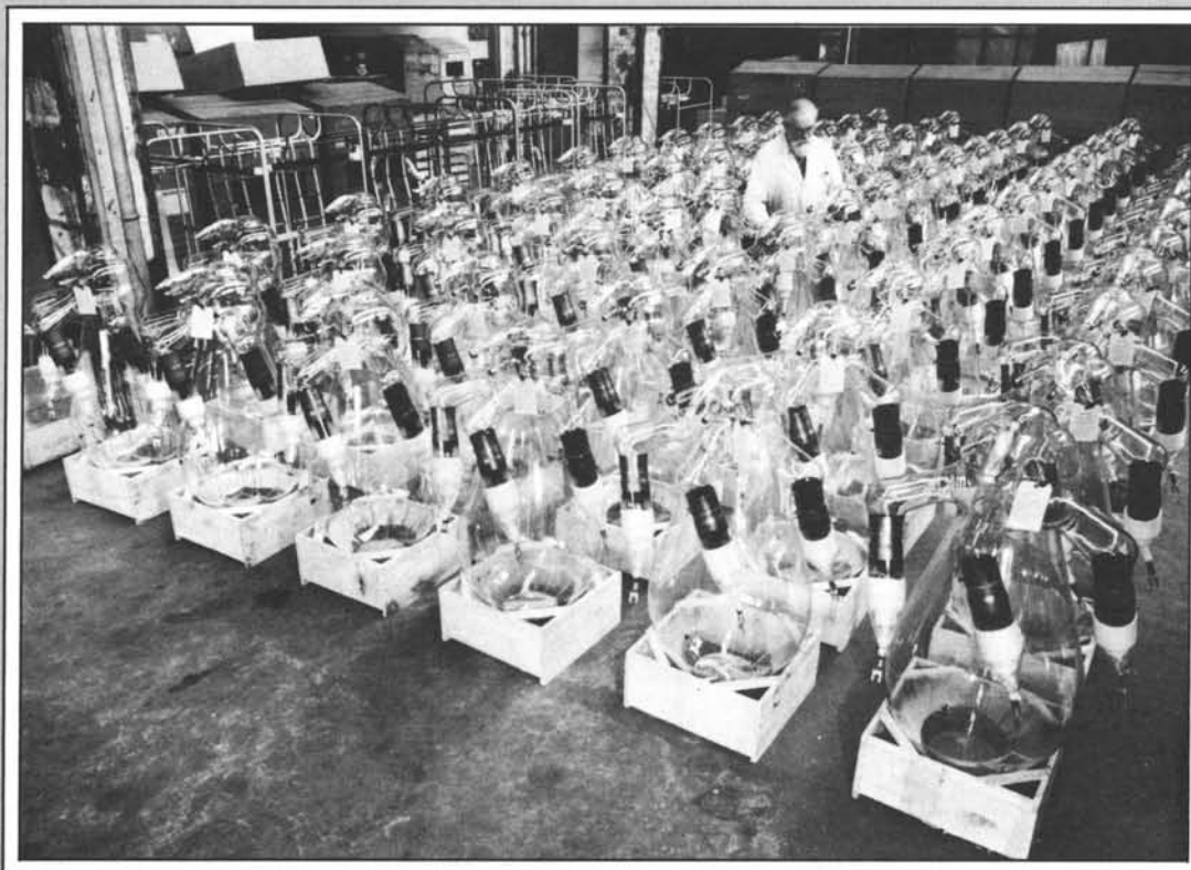
Vérification des ampoules triphasées de notre type AD 60 à l'entreprise Hewittic en 1954.
