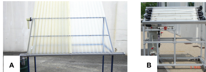
Figure 2 : Dispositif de récupération des eaux de pluie par une toiture en tôle ondulée plastique (A) et de traitement d'eau par photocatalyse (B)
