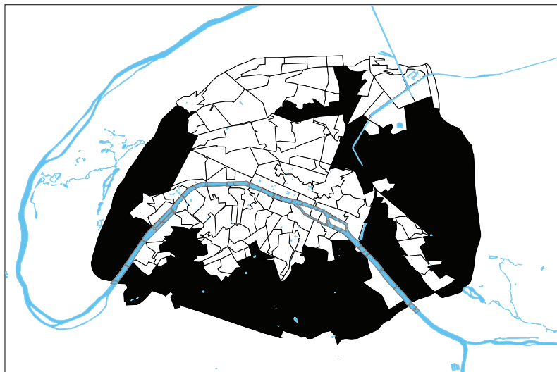
Bassins versants concomitants (0 à 15 mn) avec la pointe de débit du réseau
