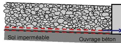
Figure 5. Evacuation vers exutoire ou en réseau d'assainissement
