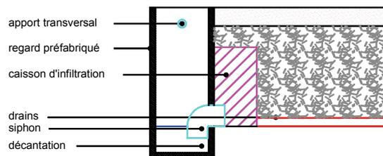
Figure 7. Regard d'injection des tranchées de rétention / infiltration.
