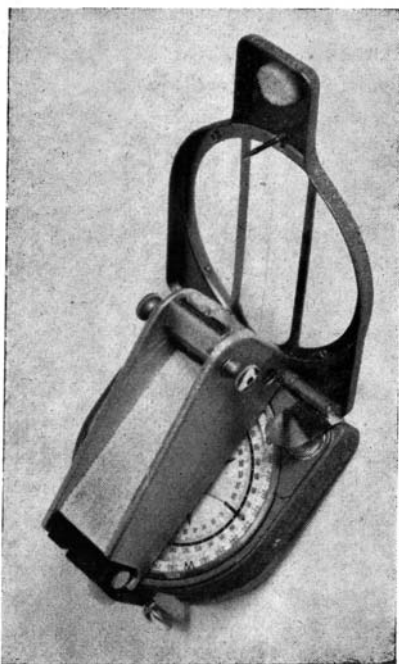
La pinnule en place sur la boussole. (Photo LOTT.)
