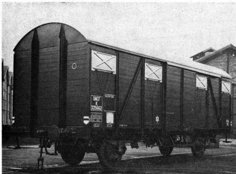
3 — Les parois de nombreux wagons couverts sont encore constituées de frises en bois de différents profils.
