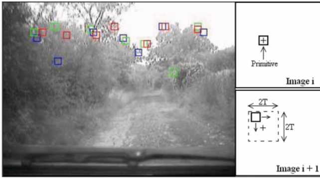
Figure 3. À gauche, primitives sélectionnées par les ondelettes de Harr sur une séquence d'images réelle. À droite, schéma de la mise en correspondance des primitives entre deux images.
