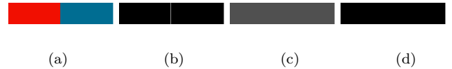
FIG. 2 – Métamérisme : (a) Image composée de deux rectangles couleur. (b) Image contour obtenue à partir de la déclivité couleur. (c) Le correspondant en niveaux de gris de (a); le métamérisme est observé. (d) Image contour obtenue à partir de la déclivité; les contours ne sont pas détectés.
