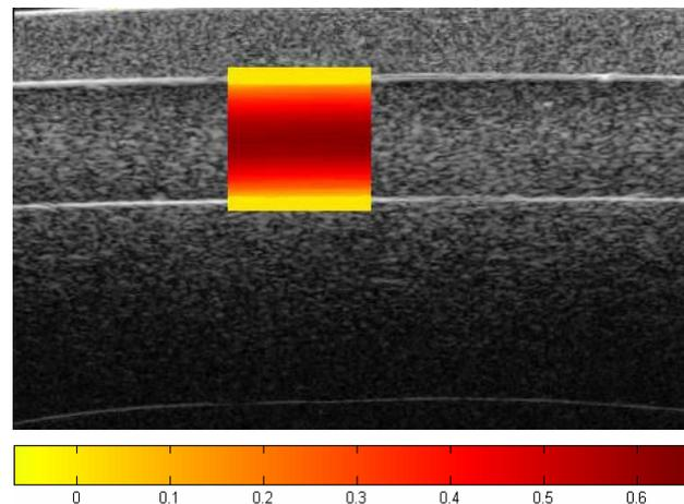
FIG. 4 Cartographie des vitesses (exprimées en mm/s)
