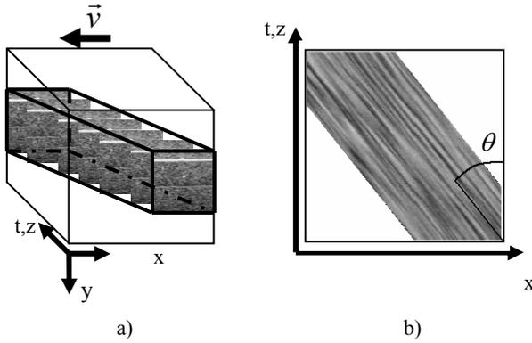
FIG. 1 : Principe de l'analyse spatiotemporelle de speckle. a) espace spatiotemporel b) coupe dans le plan xt
