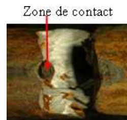
FIG. 9 – Rupture de l'essai avec fils pré-corrodés plongés dans de l'eau
