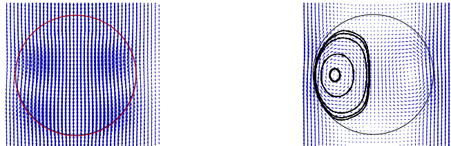
FIG. 1 – A gauche : une microgoutte confinée (ligne noire) et le champ de vitesse associé (flèches bleues) ainsi qu'un cercle parfait (ligne rouge). A droite : la même goutte avec le champ de vitesse et les lignes de courants dans le référentiel de la goutte.
