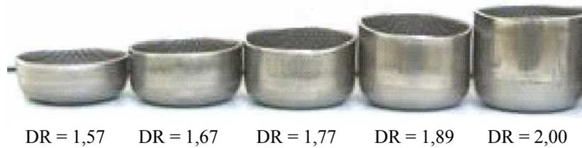
FIG.3 – Godets emboutis de l’acier 301LN avec différents rapports d’emboutissage
