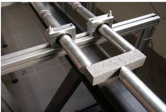
FIG. 1 – Dispositif d'essai de flexion dynamique
