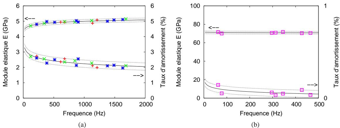
FIG. 2 – Mesure par analyse modale du module élastique  $E$  et du taux d'amortissement  $\xi$ , (a) plusieurs géométries d'éprouvette en PMMA, disque (\* bleu), poutre 300mm  $\times$  30mm (+ rouge) et 400mm  $\times$  30mm (x vert), (b) plaque d'aluminium 7049 de dimension 655mm  $\times$  319mm  $\times$  5mm (carré violet)
