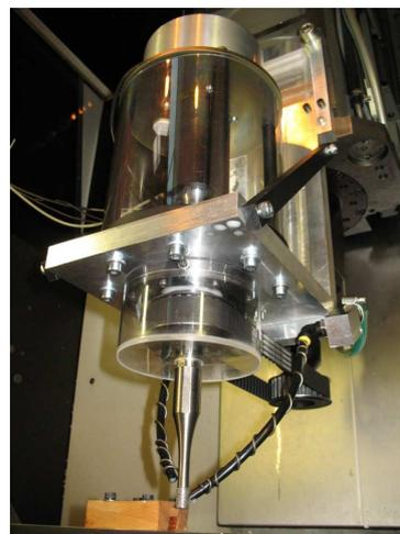
**Fig. 3** prototype usinage ultrasonore rotatif
