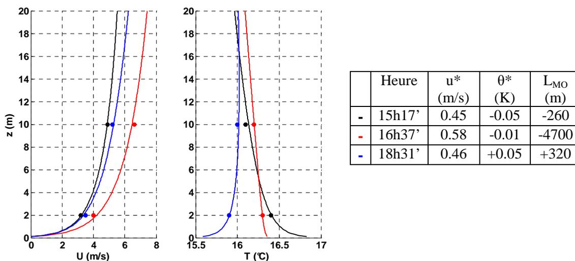
FIG. 3 – Profils moyens de vent  $U$  et de température  $T$  estimés avec les relations de similitude à partir des mesures à des hauteurs de 2 et 10 m (cercles). Ces profils correspondent aux passages de TGV de 15h17' (noir), 16h37' (rouge), et 18h31' (bleu). Les paramètres  $u^*$ ,  $\theta^*$  et  $L_{MO}$  associés à ces trois profils sont également donnés.
