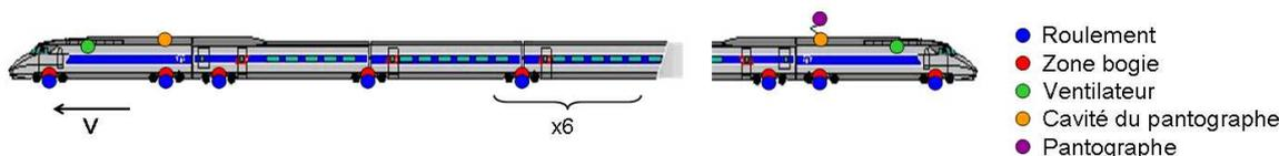
FIG. 5 – Modèle de 31 sources équivalentes pour le TGV.
