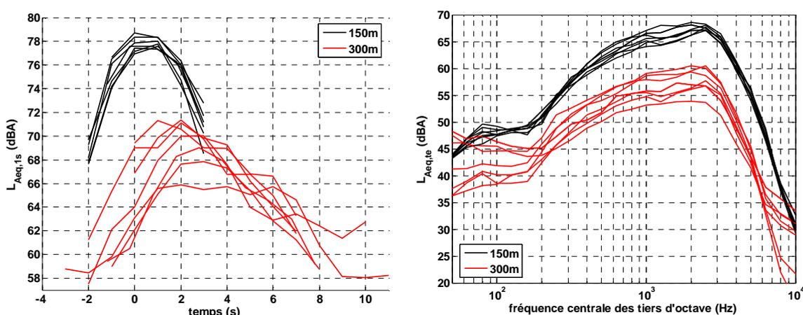
FIG. 2 – Signatures temporelles (gauche) et spectres en tiers d'octave de  $L_{eq,te}$  (droite) pondérés A pour 7 passages de TGV à 150 m et 300 m de la voie.
