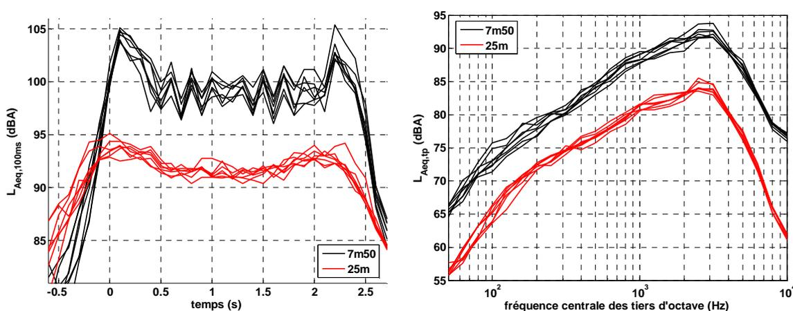
FIG. 1 – Signatures temporelles (gauche) et spectres en tiers d'octave de  $L_{eq,tp}$  (droite) pondérés A pour 7 passages de TGV à 7,50 m et 25 m de la voie.
