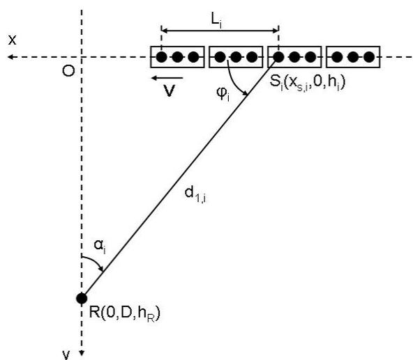
FIG. 4 – Géométrie pour le modèle de propagation et notations.
