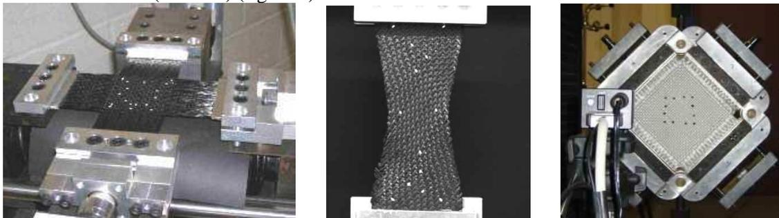
FIG. 2 – Traction biaxiale et bias test sur carbone 2.5d ; cisaillement au cadre sur Twintex
