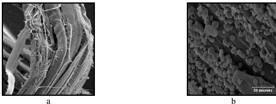
Figure 1 : Fibres de chanvre avant (a) et après leur immersion pendant 24 heures dans une solution saturée en chaux (b)
