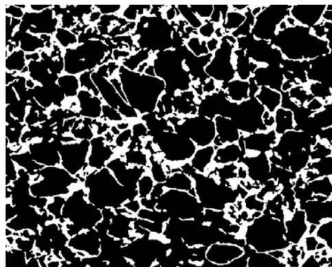
Fig 2. Résultat de la segmentation des particules d'argile.
