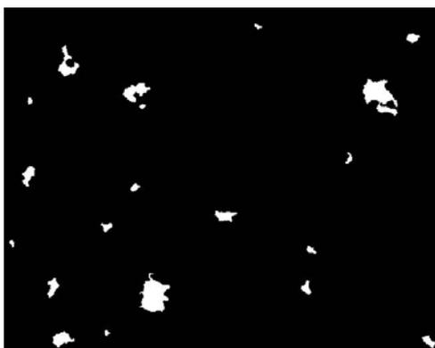
Fig. 3. Résultat de la segmentation des pores
