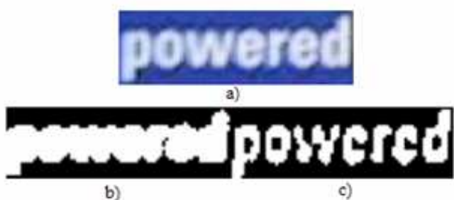
FIG. 4 – a) I , b) M obtenu par binarisation Otsu, c) I_{finale} par la méthode proposée
