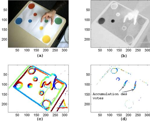
FIG. 4 – Illustration de la TC. (a) Image originale, (b) Distance à la couleur chair  $I_{tc}$ , (c) Orientation du gradient aux contour de l'image : chaque orientation est représentée par une couleur différente, (d) Matrice d'accumulation de votes.
