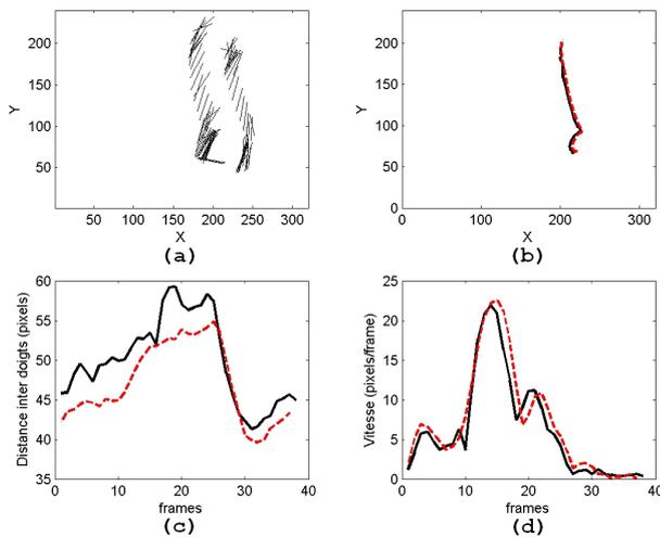
FIG. 8 – Résultats pour l'étape 1 : (a) tous les segments. (b) trajectoire du point  $p_c$  (c) distance entre les doigts (d) vitesse de la main. Dans (b), (c) et (d), les courbes en pointillés montrent la vérité terrain.
