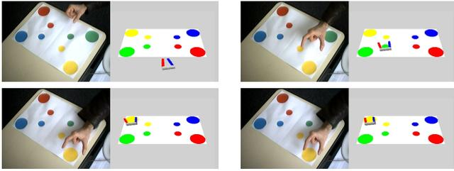
FIG. 7 – Cette figure montre des images de l'étape 1. Sur l'image de gauche, nous pouvons voir le point de vue de la caméra et sur la droite, l'environnement OpenGL avec une pince virtuelle reproduisant simultanément le geste.
