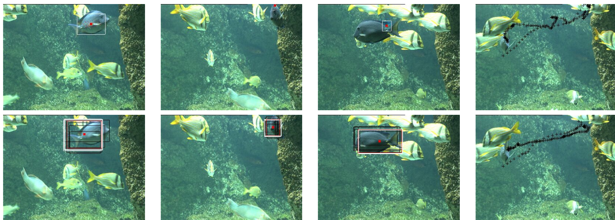
FIG. 4 – Images 180, 208, 264, 306. Première ligne : résultats du suivi avec un filtre Bootstrap conventionnel. Dernière ligne : résultat de notre schéma de suivi. A droite : trajectoires du chirurgien bleu estimées avec l’approche Bootstrap (en haut) et notre approche (en bas).
