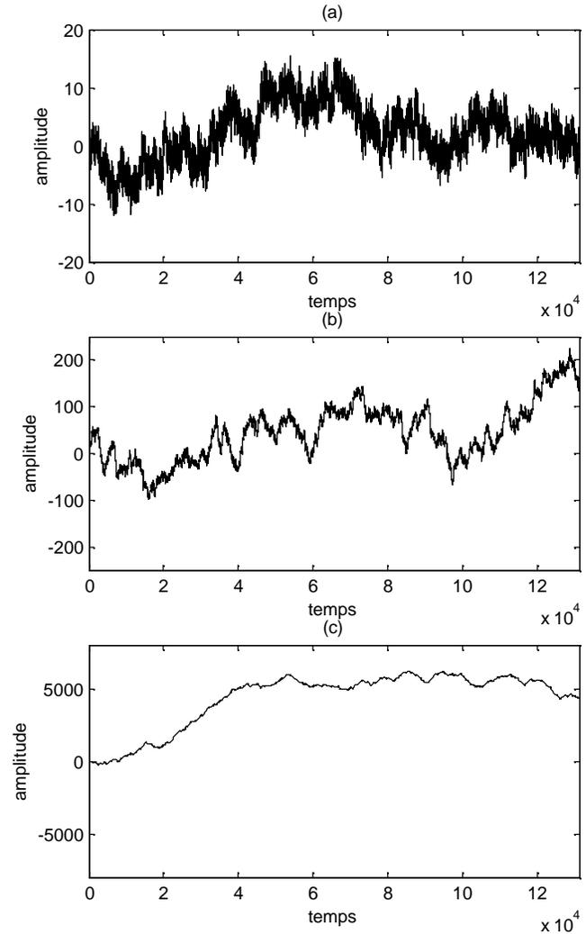
FIG. 2: Réalisations du mbf obtenues par intégration des réalisations de la figure 1 de taille  $N = 2^{17} = 131072$  échantillons pour  $H = 0.2$  (a),  $H = 0.5$  (b) et  $H = 0.8$  (c).
