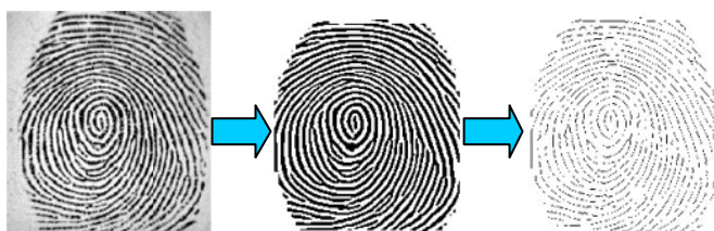
FIG. 2 : synopsis du pré-traitement des images d'empreintes digitales en vue de l'extraction des minuties
