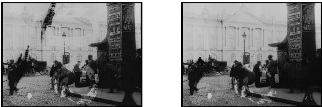
Figure 3 : Suppression de dropout : extrait de la séquence des Frères Lumière (1895). A gauche, séquence originale numérisée, à droite, séquence traitée.
