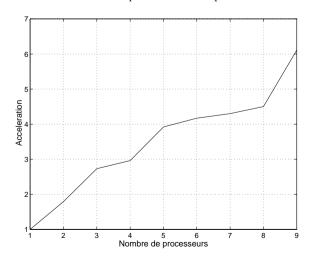
Fig. 3: Accélération de la machine parallèle.
