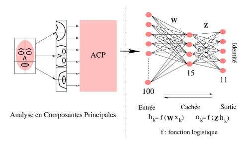
Fig. 1: Système d'identification de visages.
