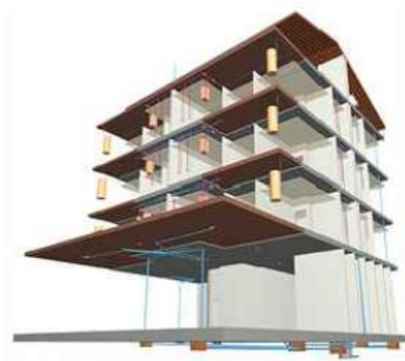
Ilustración 19. Sistema de recolección aguas lluvias
