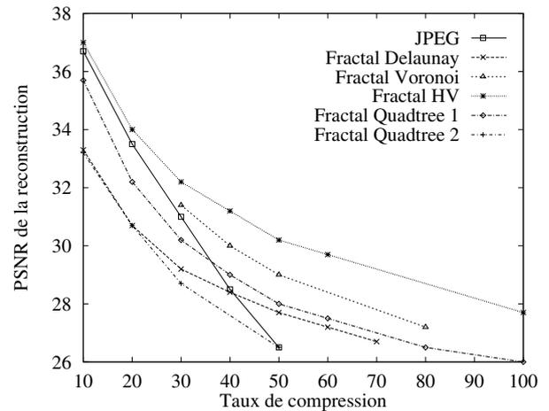
FIG. 7 — Comportement de différents algorithmes de compression sur l'image lena  $512 \times 512$ .
