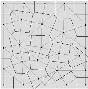
Une approche par **Division-Fusion** a été retenue pour la construction d'une partition de Voronoï adaptée au contenu d'une image (constituée de polygones homogènes). Celle-ci se caractérise par les trois phases suivantes :
