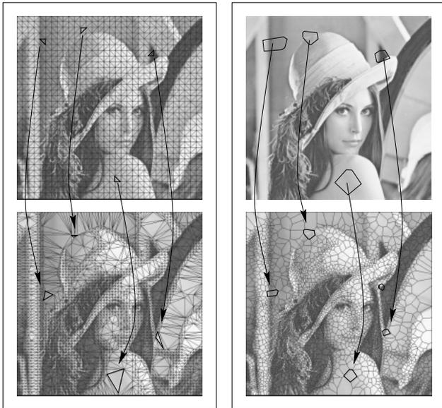
FIG. 6 — Principes de collage. A gauche : deux triangulations de Delaunay. A Droite : une seule polygonalisation de Voronoï.
