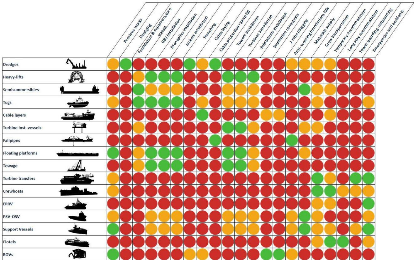
Fig. 1. Clasificación COVEMA (Construction Vessels Matrix)
