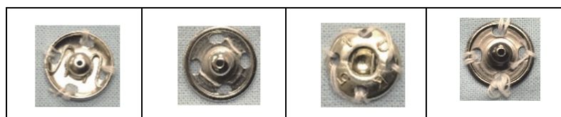
図 4 スナップ付けを正しく行えていない例
