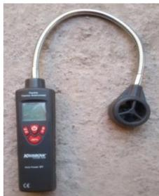
Gambar 8. Anemometer *digital*
