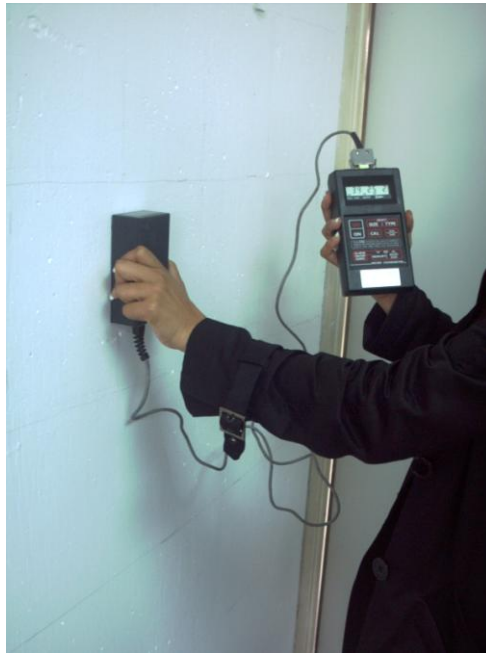
Figura II.2. Detección del acero de refuerzo
