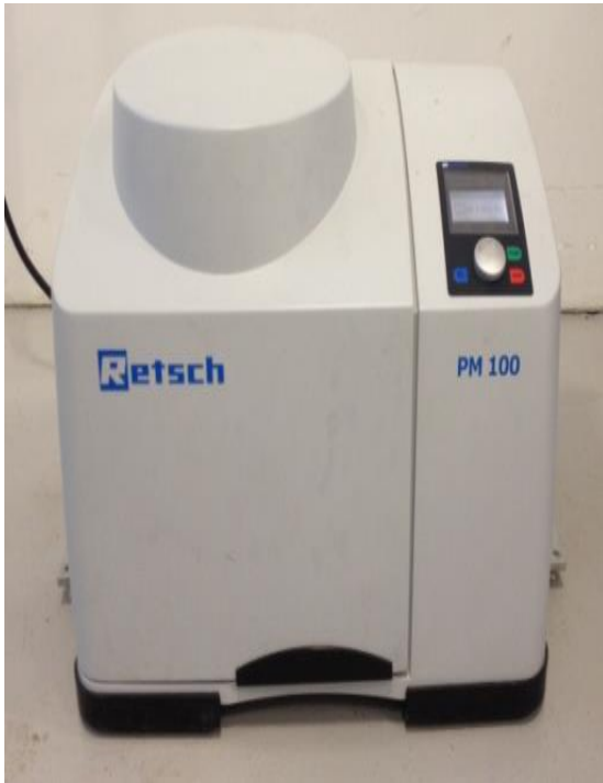
Figura 5. Molino de alta energía tipo planetario y recipiente de acero inoxidable.
