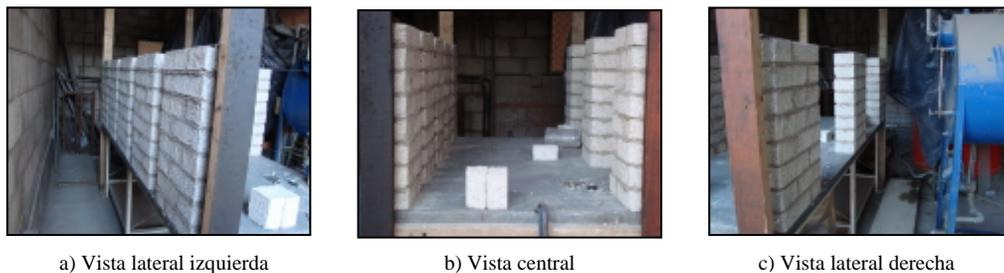
**Figura 3.4. Resultado final de los muretes empleando hilos para cuidar la verticalidad de 3 de los costados**
