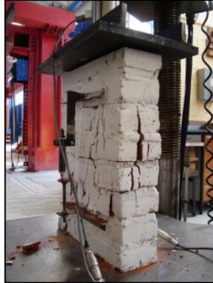
Figura 2.5. Falla por agrietamiento vertical de las piezas
