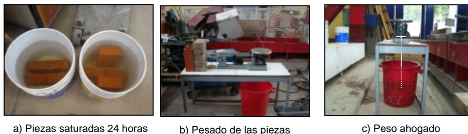
Figura 3.7. Prueba de absorción total a las 24 horas
