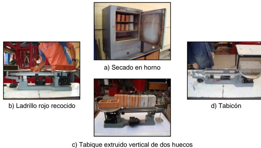
**Figura 3.5. Determinación del peso volumétrico de las piezas**
