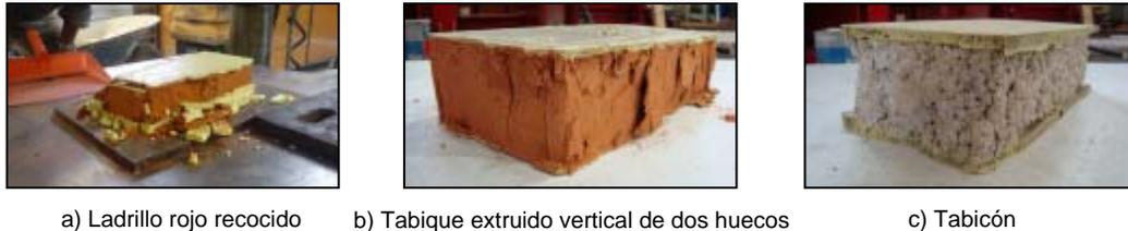
Figura 3.8. Resistencia a compresión de las piezas
