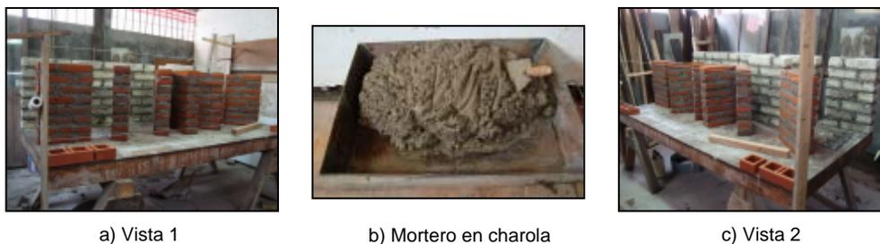
**Figura 3.3. Construcción de los muretes**
