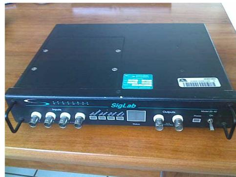
Figura 4.2. Sistema de adquisición de datos SigLab
