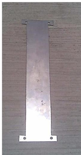
Figura 3.15. Probeta real con 30% del área reducida.
