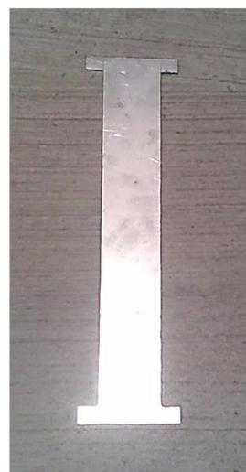
Figura 3.16. Probeta real con 40% del área reducida.
