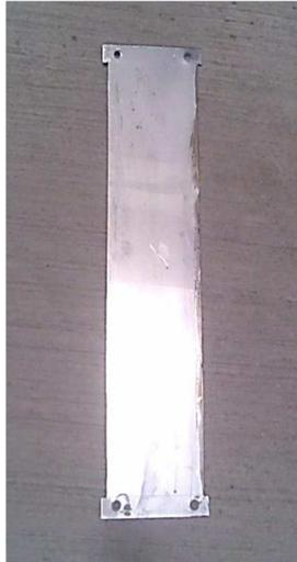
Figura 3.13. Probeta real con 10% del área reducida.
