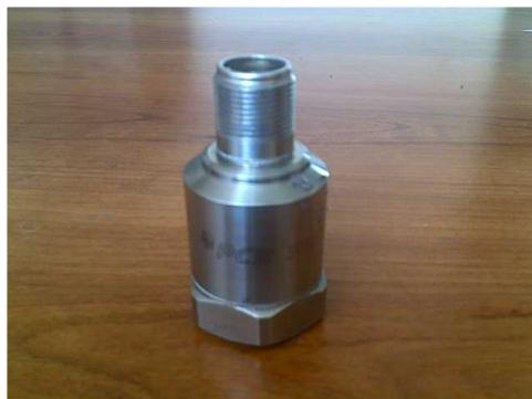
Figura 4.3. Acelerómetro sísmico piezoeléctrico.
