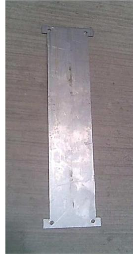
Figura 3.14. Probeta real con 20% del área reducida.
