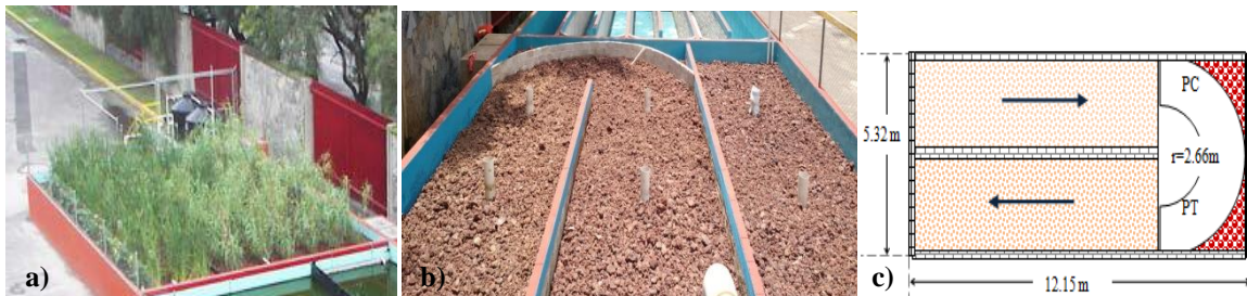
Figura 1.5. a) Humedal de Flujo sub-superficial b) Detalle de la curvatura en cambio de canal c) Vista real de la curva
