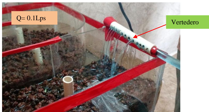
Figura 5.5. Funcionamiento de vertedero a escala 1:20
