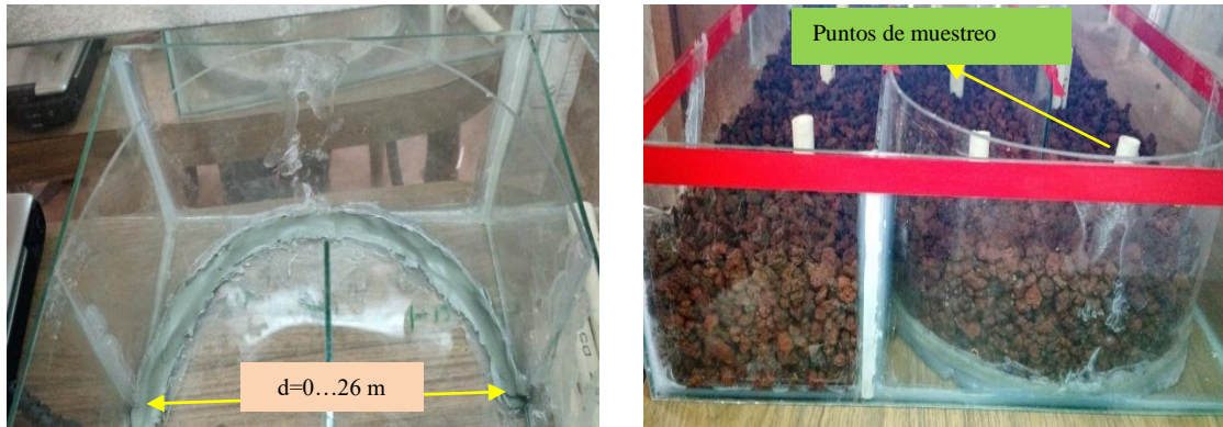
Figura 5.4 a). Representación de curva con chaflán en el prototipo b) curva con material tezontle en prototipo
