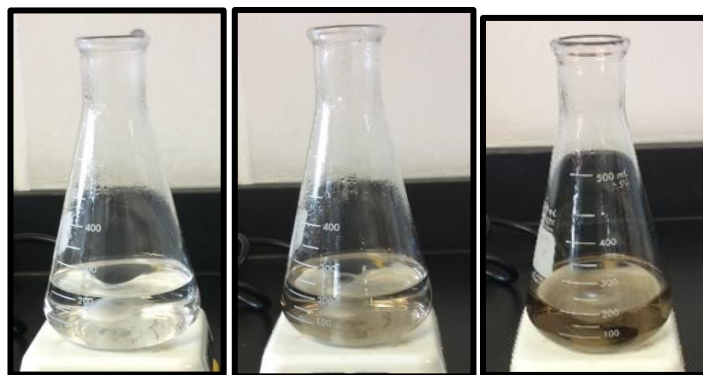
Figura 5. Cambio de color de la solución durante la síntesis de NPs de Pt.
