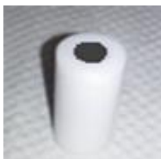
Figura 8. Electrodo de carbón vítreo modificado con la tinta catalítica.
