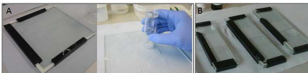
Figura 4.4. a) Preparació i tall de la capa de difusió b) Preparació dels gels receptors
