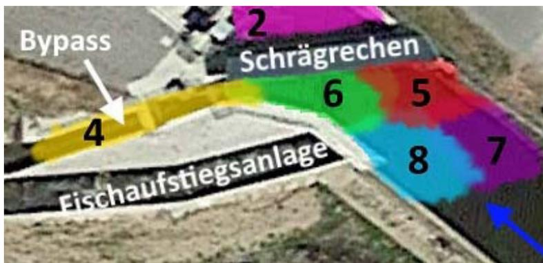
Abb. 165: Antennenbereiche am Schrägrechen (Quelle: verändert nach Wüst auf Basis von Google.maps, 2016).
