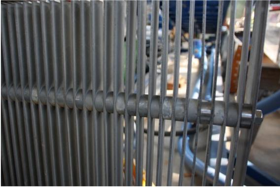
Abb. 52: Alternativrechen mit filigranen Rechenstabdicken (hier wurde die vertikale Ausrichtung fotografiert).
