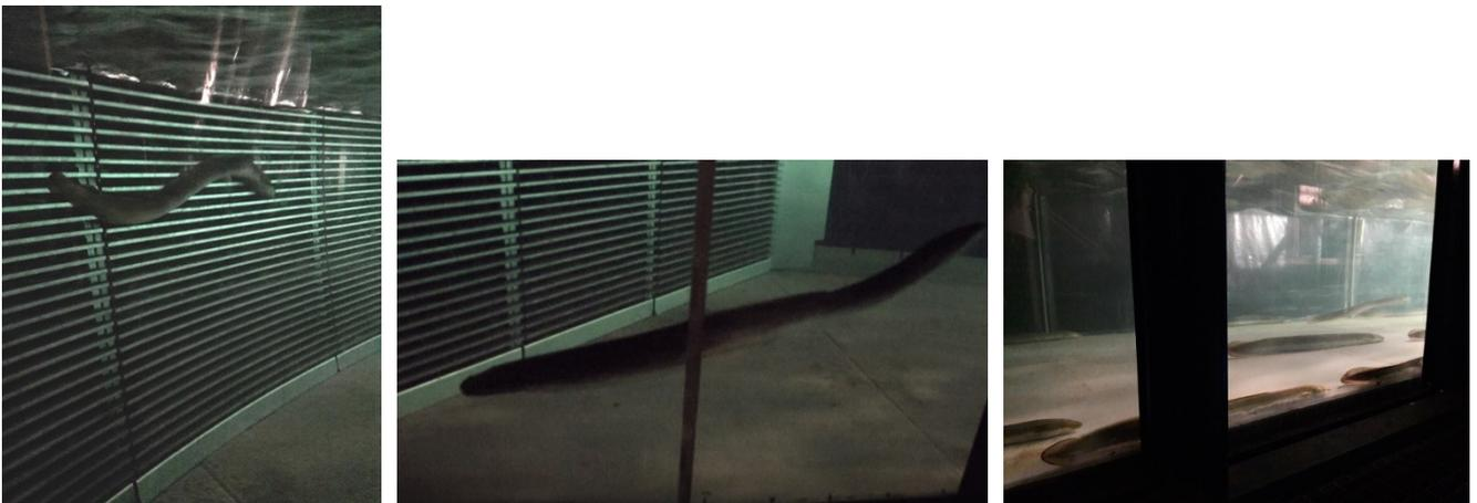
Abb. 159: Aale mit Kontakten zum Rechen nahezu an der Wasseroberfläche bei Versuch-Nr. V12.1 (links), direkt vor der Plexiglas-scheibe der linken Rinnenwand während der aktiven Abwanderung Richtung Bypass im Versuch-Nr. V6.2 (Mitte) sowie während der Abwanderung in der Versuchsrinne an der Sohle bei Versuch-Nr. V10.1 (rechts).
