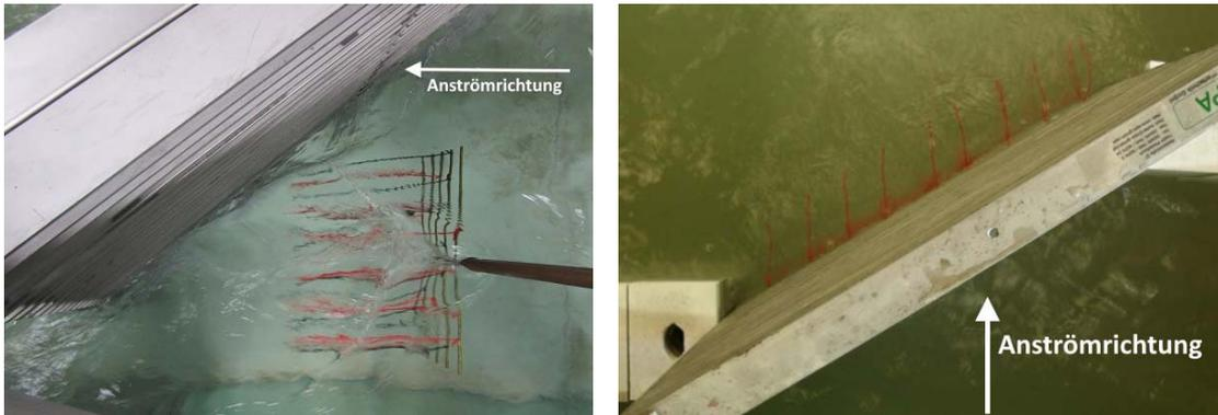
Abb. 12: Fadenharfe am Schrägrechen im Labor der TU Darmstadt (links) und unterwasserseitige Wollfäden am Schrägrechen im Labor des KIT (Quelle rechts: Nestmann, 2010).
