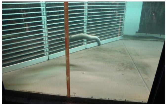
Abb. 146: Links: Versuch-Nr. V19.3 mit einem Aal, der sich zwischen die Rechenstäbe gewunden hat und so über die gesamte Versuchsdauer verharrte. Er ist mit seiner Position bei Schrägrechen an Wasserkraftanlagen durch den Rechenreinigungsarm gefährdet, der ihn wahrscheinlich verletzen oder töten würde. Rechts: Versuch-Nr. V24.2 mit einem Aal, welcher an den Schrägrechen angedrückt wurde. Er löste sich jedoch nach 4 Minuten und wanderte entlang der Rechenebene über den Bypass ab.
