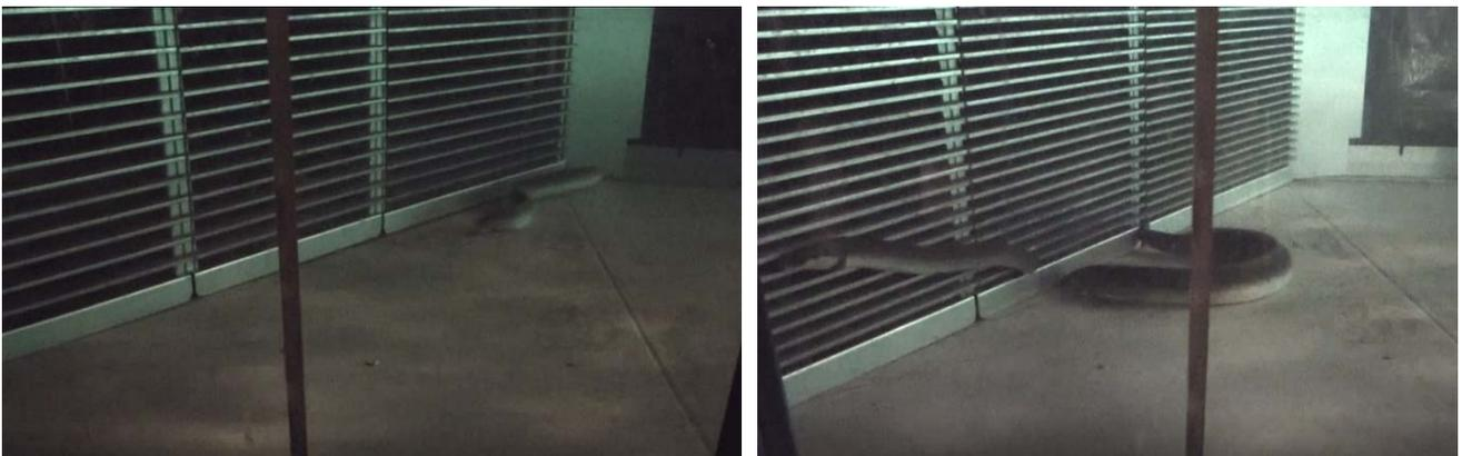
Abb. 151: Links Aal im Versuch-Nr. V21.1 kurz vor der Kollision mit dem Schrägrechen, seine Körperhaltung war anguloform ausgebildet, er driftete passiv auf den Rechen. Rechts Aal im Versuch-Nr. V5.1 im Augenblick der Kollision mit dem Schrägrechen, seine Körperhaltung war ebenfalls anguloform ausgebildet. Links neben dem Aal (rechte Abb.) verharrte ein Aal auf der Rechenebene.
