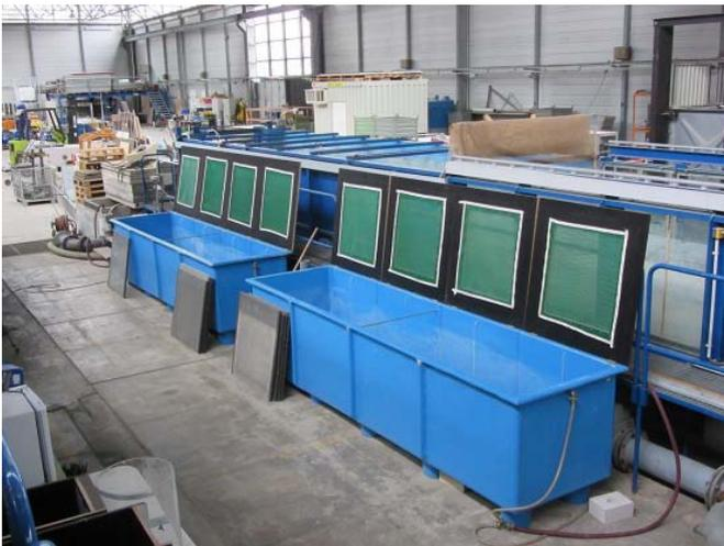
Abb. 79: Hälterung im wasserbaulichen Forschungslabor mit Frischwasserzuleitung und Belüftung.
