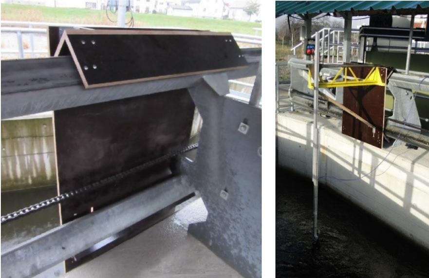
Abb. 66: Links für das Rechenschienensystem in Ottenau entworfener Messwagen auf der Rechenführung aufliegend und rechts in der Seitenansicht mit Aluschienen, an welchen das Messgerät befestigt war (*Quelle rechts: Schwab, 2016*).
