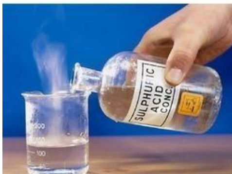
Gambar 7. Asam sulfat harus ditambahkan ke dalam air, bukan sebaliknya.
