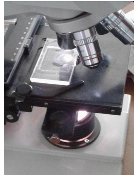
Figura 10: Conteo de nematodos con la cámara potter en el microscopio.
