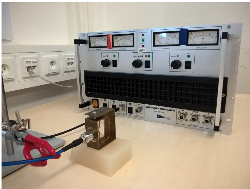
Obrázek 3.1.11: Umístění anténního elementu pro frekvenci 434 MHz vzhledem k fantomu.
