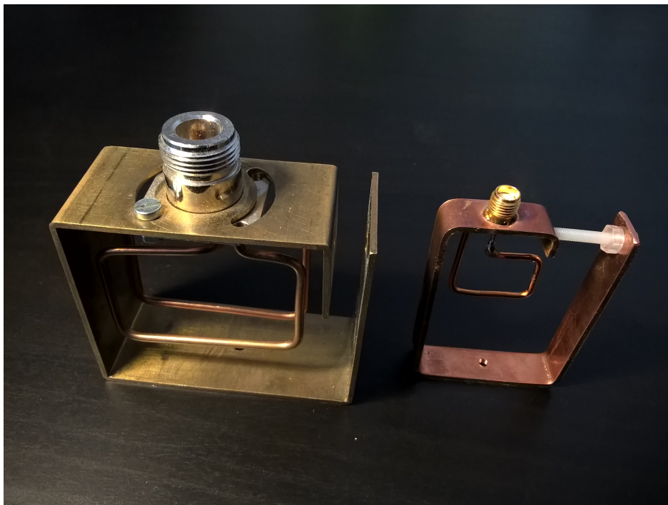
Obrázek 2.4.3: Budící smyčky pro obě pracovní frekvence
