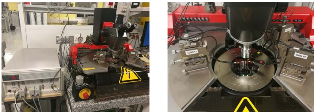
Figure 132 : station de mesures sous pointes avec le traceur Agilent 4142B
