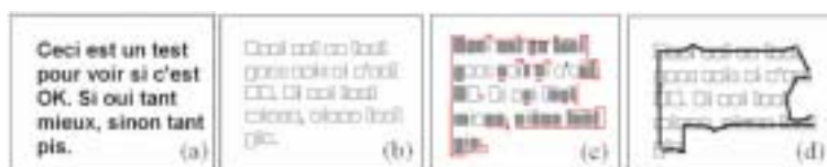
Figure 4. (a) Image initiale, (b) composantes connexes, (c) en gris : composantes de contour, en rouge : côtés sans voisin, (d) chaînage circulaire obtenu.
