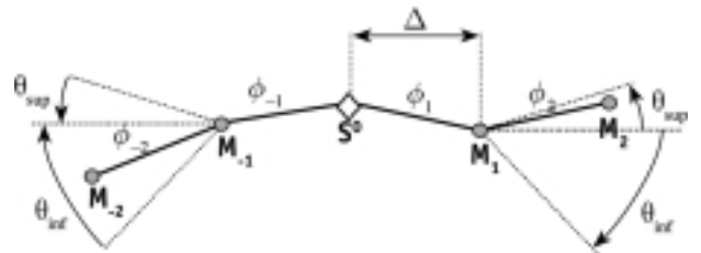
Figure 13. Depuis le germe S^0 , le snake s'accroît par ajout de points à droite et à gauche suite à la maximisation de \vec{R}_{top} à travers chaque nouveau segment.
