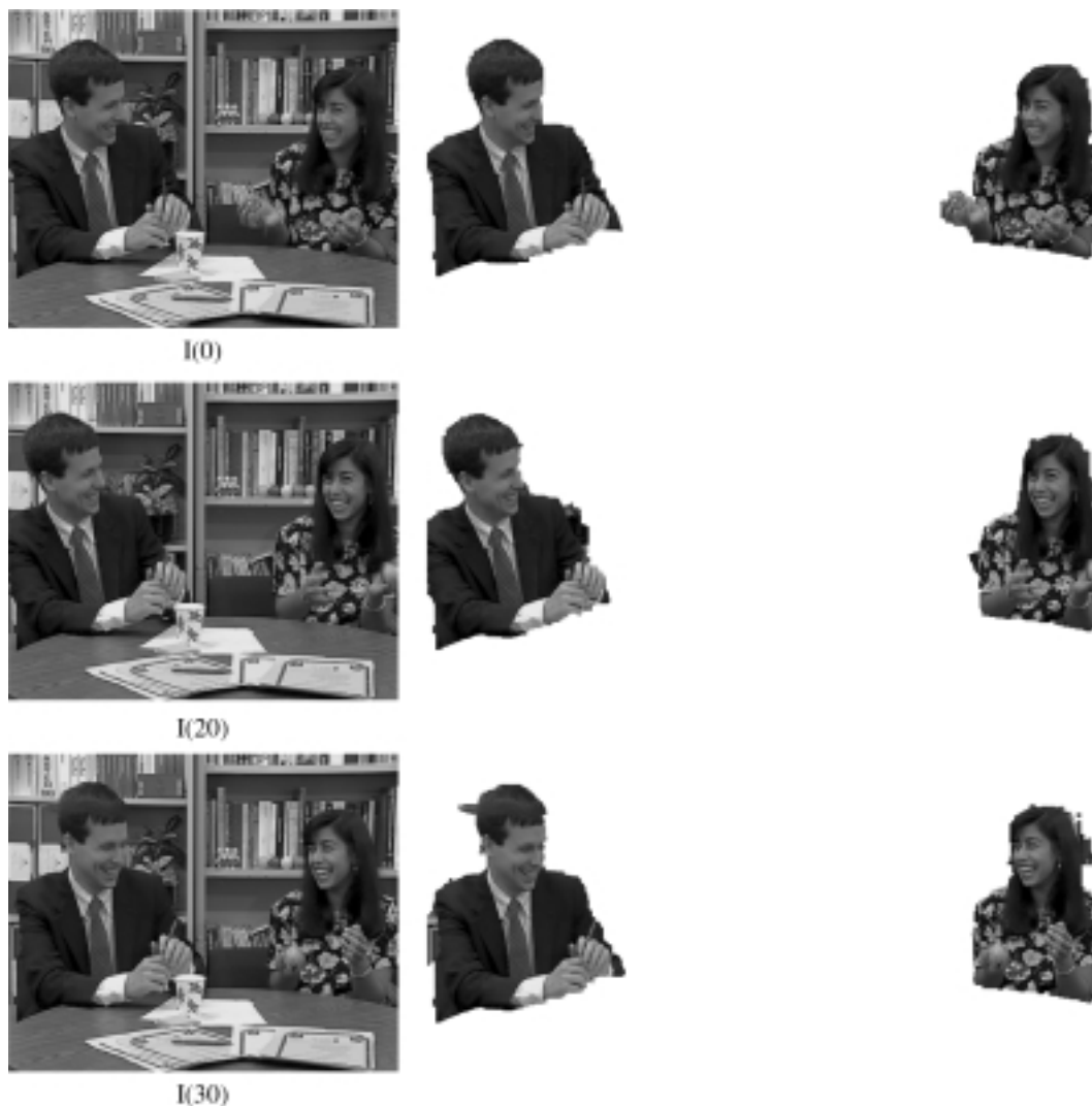
Figure 18. Segmentation d'objets vidéo évoluant dans la séquence hétérogène Paris (La première colonne représente les images originales à 3 instants différents, les deux autres colonnes donnent les objets vidéo segmentés).
